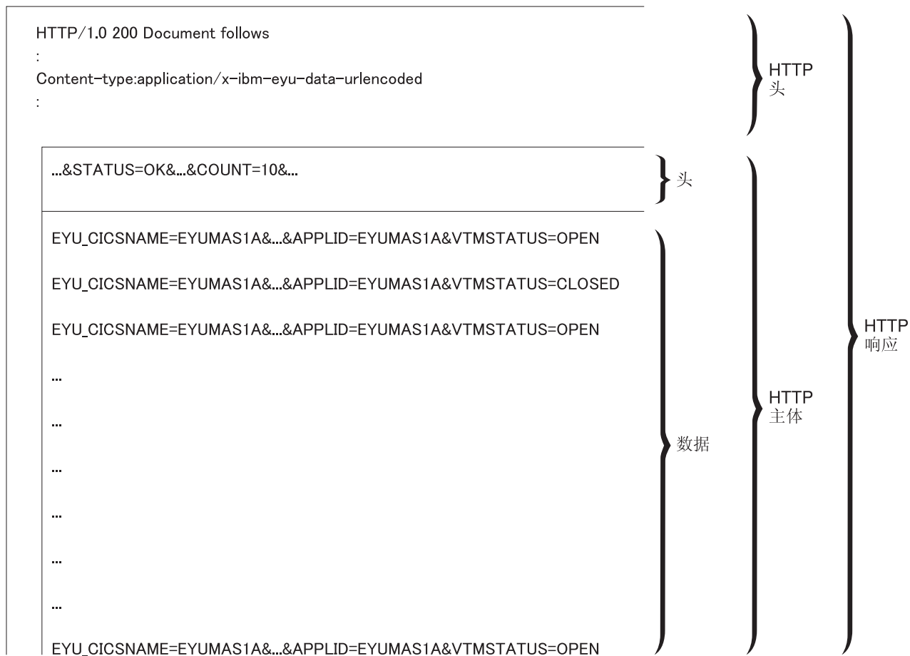
图 50. 针对数据接口请求的 HTTP 响应的结构
