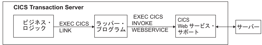
図 20. ラッパー・プログラムを使用した、Web サービス・リクエスターとしての CICS アプリケーションの配置
