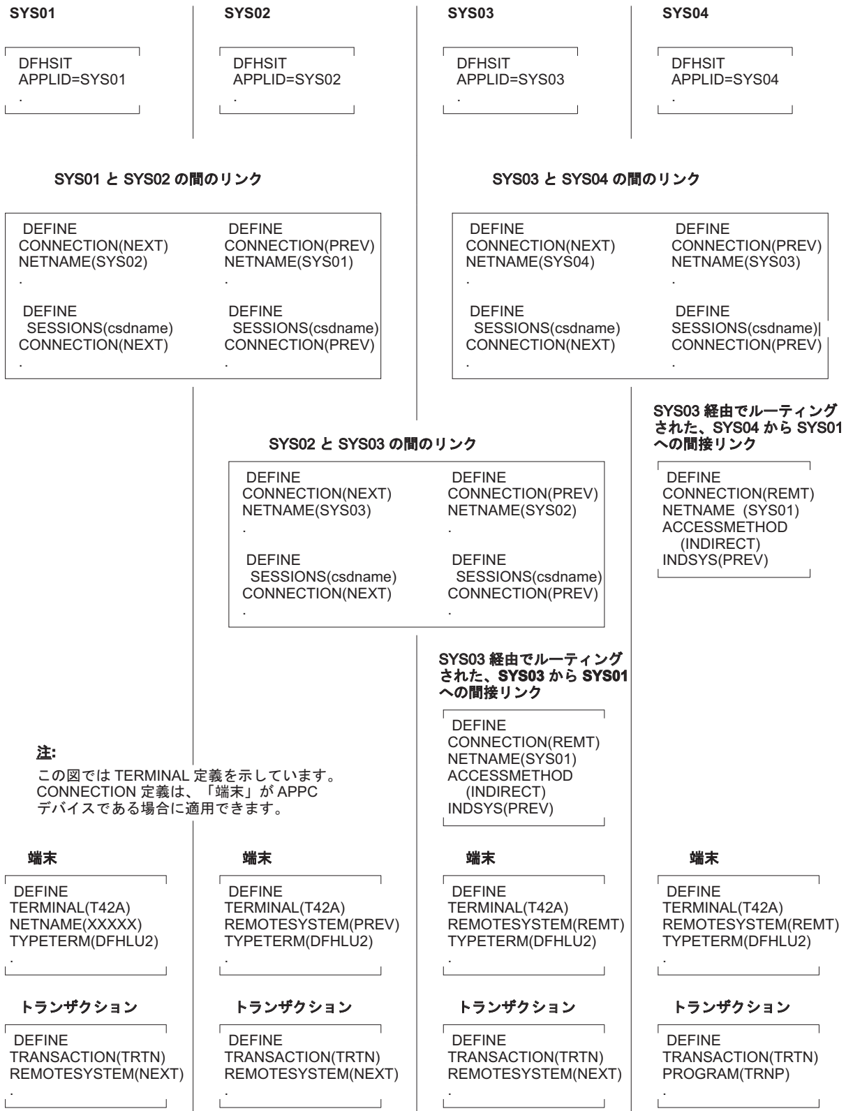
図 48. トランザクション・ルーティングのための間接リンクの定義：SYS04 と SYS03 のリモート端末定義には REMOTESYSNET オプションが指定されていないので、間接リンクが必要です。
