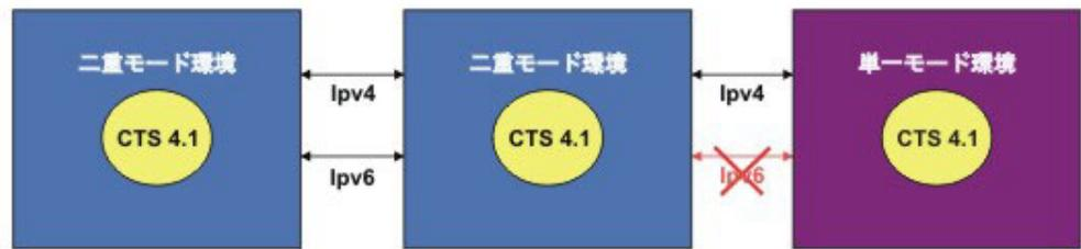
図は、CICS-CICS 間通信を示しています。ここでは、2 つの二重モード CICS TS 4.1 環境が IPv4 アドレッシングか IPv6 アドレッシングを使用して通信できます。二重モード CICS TS 3.2 環境も接続されていますが、IPv4 のみを使用して通信できます。
